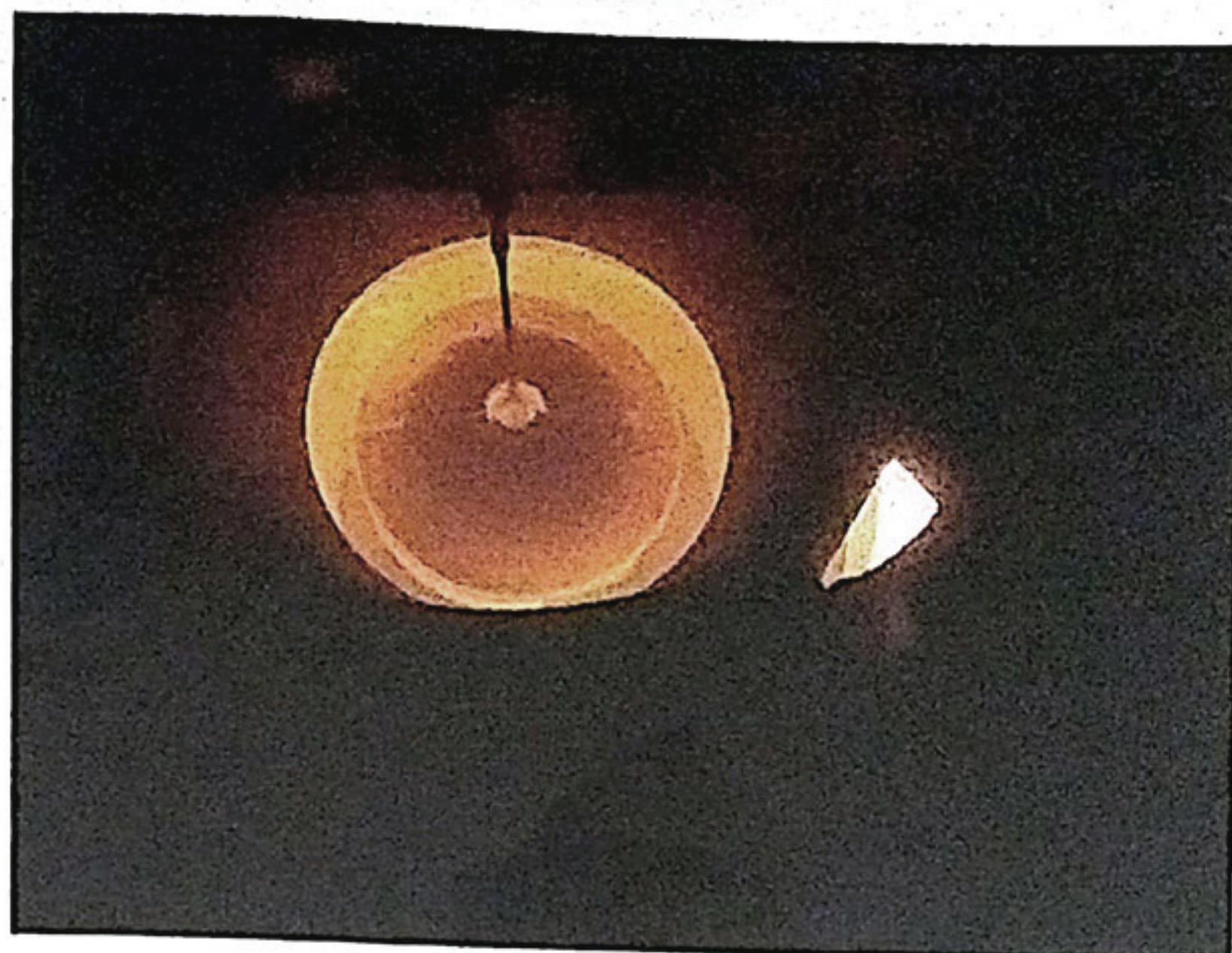
Рис. 1. Фото процесса выращивания монокристалла
