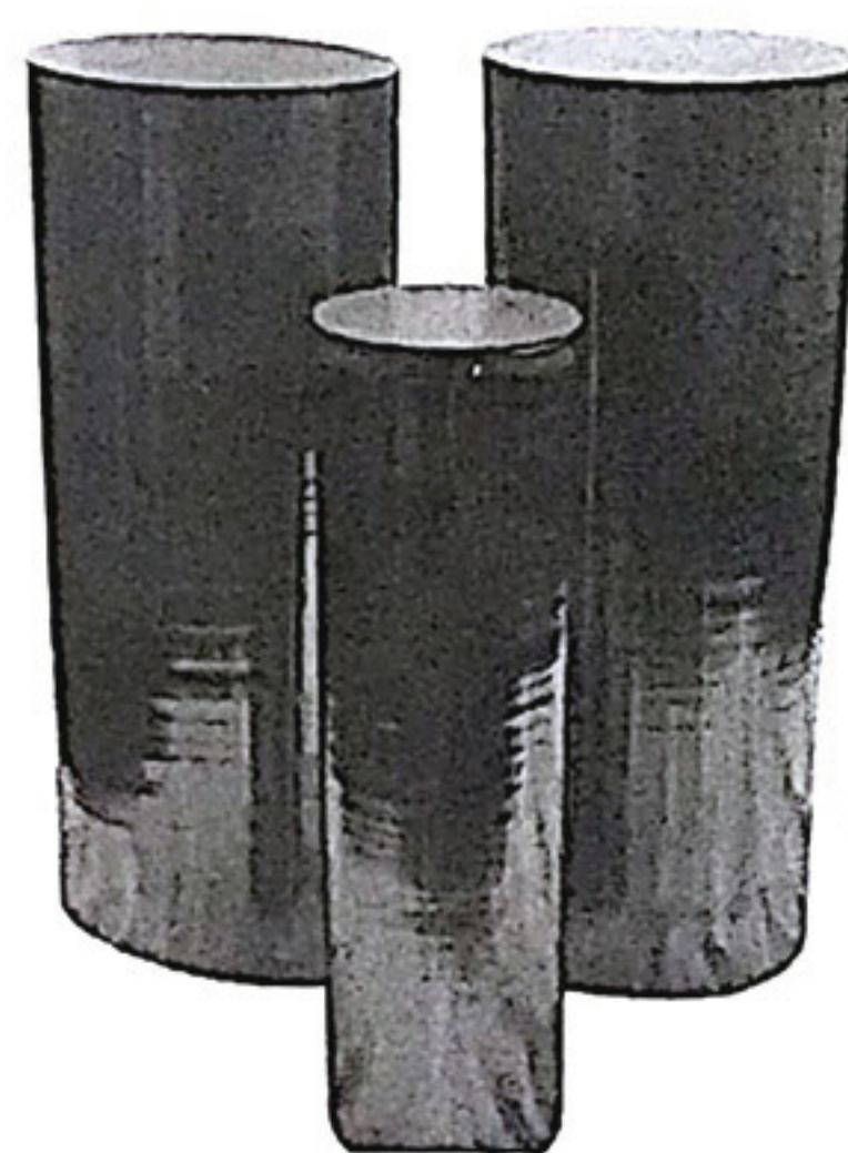
Рис. 2. Фото выращенного слитка кристаллического кремния
